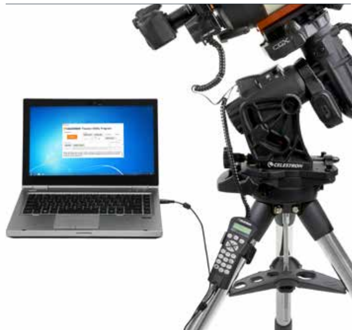
Der Fokussiermotor wird über eine Halterung von Celestron von einem Computer gesteuert.
