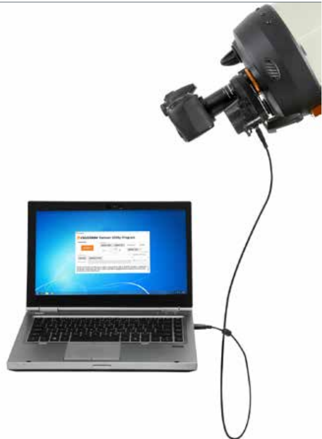
Der Fokussiermotor wird direkt von einem Computer über seinen USB-Port gesteuert.
