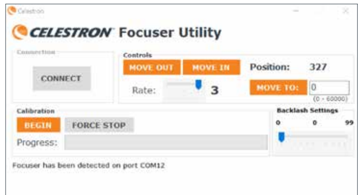
Das kostenlose Fokussier-Dienstprogramm von Celestron bietet eine einfache Benutzeroberfläche zur Steuerung des Fokussiermotors.
